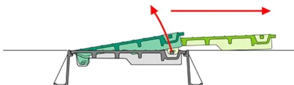
Ce coffre est conforme à la norme européenne EN 124 Classe C 250 (charge de 250 kN)
