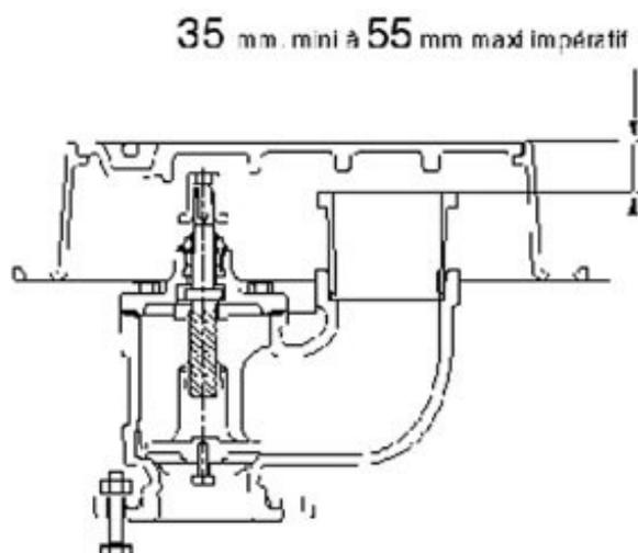
Au moment de l'installation de la bouche et de son raccordement à la canalisation, il est nécessaire de tenir compte de l'encombrement du tampon quand le coffre est ouvert, par rapport à l'environnement : bordure de trottoir, maison, etc.
