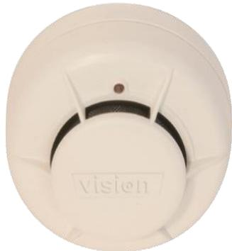
Détecteur optique conventionnel de fumé avec un profil extra mince et une LED de signalisation. Supervision de fonctionnement à travers le clignotement de la LED. La conception de la chambre de détection réduit les effets d'encrassement et accessible sont nécessite d'outils spéciaux pour la maintenance. Incorpore un micro capteur activable par un faisceau Laser codé pour test. Sortie pour piloter l'indicateur d'action.
