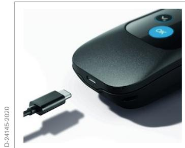
Interface USB-C pour le chargement facile de la batterie au lithium (fixe ou en mouvement)
