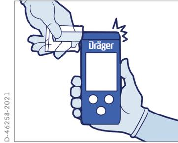
La fixation est possible sans aucun contact direct avec l'embout buccal.
