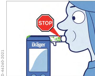
Le clapet anti-retour rend impossible l'inspiration d'air potentiellement contaminé.
